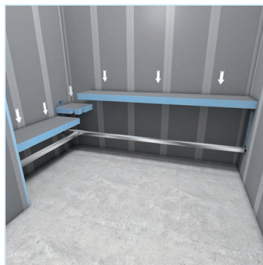
Siddefladerne limes til væg, til hinanden og til profilerne med wedi 610 og monteres.
