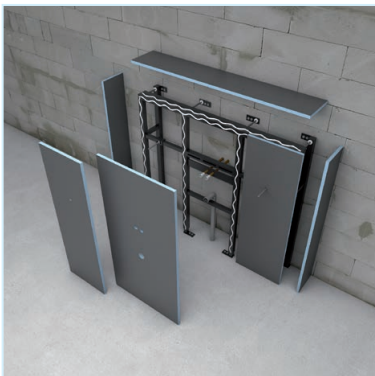
wedi byggeplade monteres med den nødvendige klargøring til montering af afløb og limes fast til håndvaskens installationsramme med wedi 610.
