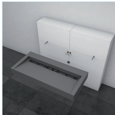
wedi Sanbath håndvask placeres på beslagene gennem installationsrammen. Kan evt. forsynes med sanitær-kit på bagsiden.
