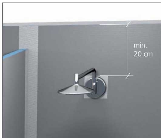
Afbeelding 3: wandafdichting minstens 20 cm boven wateraftappunt
