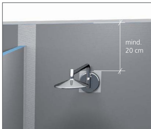
Abbildung 3: Wandabdichtung mind. 20 cm über Wasserentnahmestelle
